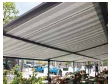
Mittige Leitrohre sorgen ab 350 cm Ausfall für geringeren Tuchdurchhang
