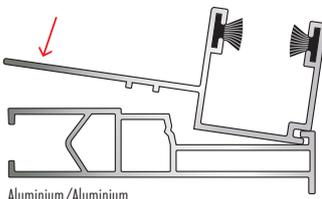
merkmale. Unschlagbar in Sachen Haltbarkeit und thermische Trennung bei Führungsschienen ist die Kombination Aluminium/Kunststoff. Durch die unterschiedliche Wärmeleitfähigkeit werden Kältebrücken vermieden und ein zusätzlicher Beitrag zur Energieeffizienz geleistet. Aber auch reine Aluminiumsysteme sind manchmal sinnvoll.
